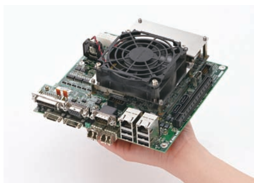
COM Expressキャリアボード ASB-1300 17cm×17cmの基板サイズ。 小型画像処理向けプラットフォーム。
