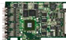
画像入力ボード APX-3311 4台のカメラを独立入力可能
