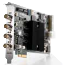
CoaXPress I/F対応 画像入力ボード APX-3662 新たな国際規格のI/F CoaXPress対応した画像入力ボード。
