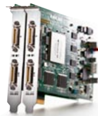
APX-3318とPSM-3318-02 画像入力モジュールとしてお客様のカスタマイズも可能にした主力機種。
