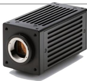
ABA-003IRは、VGA解像度、ピクセルサイズ20ミクロン、950nmから1700nmに感度を持つInGaAsセンサーを1個使用した単板式の短波長赤外SWIRカメラです。既存の可視光を用いた一般的なカメラでは撮影不可能な被写体の変化や成分を算出できます。
