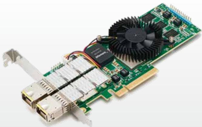
APX-EXSA10は、超高速エンジンを1機搭載し、ビッグデータを超高速で全件検索可能なボードです。エンジンはIntel社FPGA Arria10GXを搭載。将来拡張用としてノード間通信用の40Gbps光モジュール2chも実装しており、クラスタリング等システムのスケラビリティを高めることが可能です。
