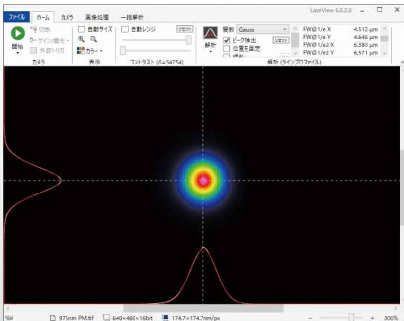
ビームプロファイラ with M2 プラットフォームソフト LaseViewは、ABA-001IR-GEと汎用PCをビームプロファイラとして利用することができる、高機能で汎用的なレーザービームプロファイラのソフトウェアです。極めて低コストかつ実用的なビーム計測システムを容易に構築することができます。
