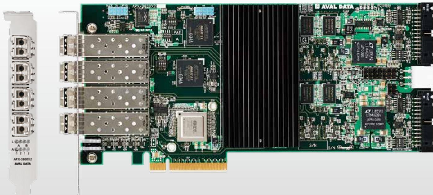
カメラと入力ボードを光ファイバでつなぐ：Opt-C:Link。1chあたり6.25Gbpsの転送速度で、CameraLink同等の性能を持ちながら、ノイズに強く、数百メートルの接続も可能、画像データと制御信号も同じ光通信で実現でき省配線にも貢献するインターフェースです。APX-3800X2は、Opt-C:Link/6.25Gbps×2ch構成の回路を1枚のボード上に2系統搭載したPCI Express×8（Gen2）規格の画像入力ボードです。
