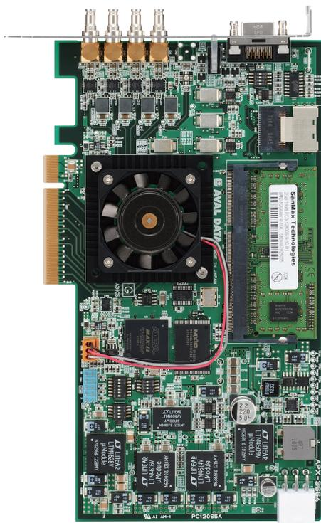
PCI-Express規格のCoaXPress(CXP)画像入力ボード。CoaXPressのQuadカメラ1台またはDualカメラ2台またはSingleカメラ2台を接続可能です。PCI-Express部はPCI Express 2.0×8 (Gen2) 5.0GT/Sインターフェースを装備し、PCに装着して高速なイメージキャプチャーを実現。オンボード上にFIFOメモリやWorkメモリとして使用可能なDDR3 SO-DIMMを装着しています。
