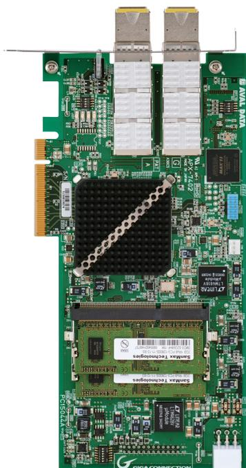
光ファイバーケーブルを用いて1対1、または複数のシステム間で情報を超高速に通信するGiGAシリーズの新たな製品GiGA CONNECTION。PCI Express規格に準拠した拡張アダプタカード。通信に必要なプロトコル処理は全てハードウェアで行うため、ソフトウェアの負担が少なく、システム構築が容易におこなえます。
