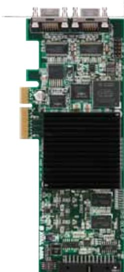
APX-3307はPCI-Express規格、LowProfileサイズのCamera Link I/Fボード。最大カメラ2台を接続。大容量のFPGAを搭載することで、カスタマイズした画像処理を搭載できます。512Mバイトのオンボードメモリを搭載しています。
