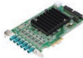
画像入力ボード (GVIFフレームグラバ) APX-3701
