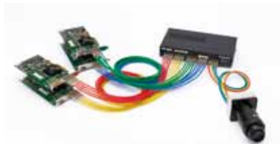
CoaxPressスプリッター AEB-3664 CoaxPressカメラからの 入力を分散処理するた めの装置
