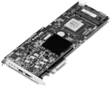
写真1 高速A-D変換ボード APX-500-414の外観
